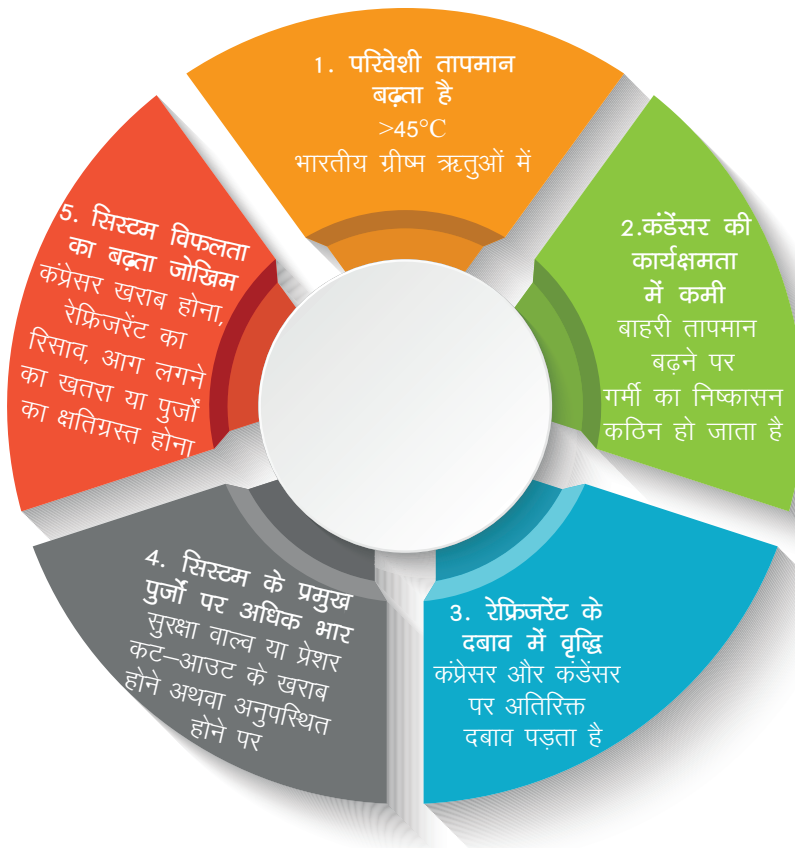
चित्र 2: अत्यधिक गर्मी की परिस्थितियों में कूलिंग सिस्टम पर पड़ने वाले यांत्रिक जोखिम
